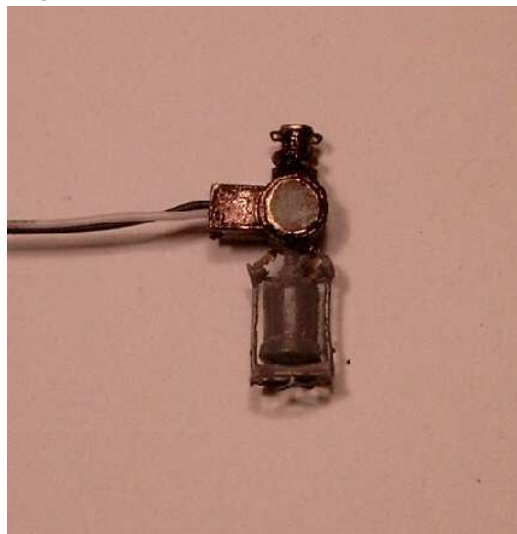
Fertig montierte und lackierte Lampen
